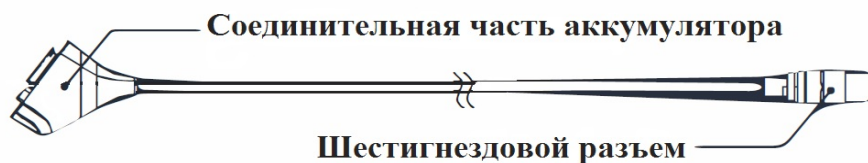
Рисунок 10. Соединительный провод блока обработки сигналов с батарейным блоком НТН
