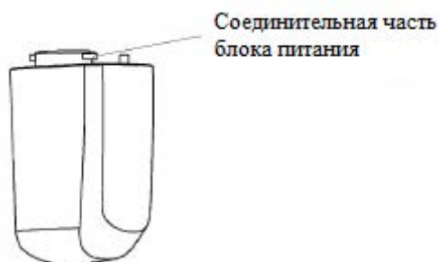
Рисунок 8. Аккумуляторный блок питания для заушного типа ношения (ЗТН)
