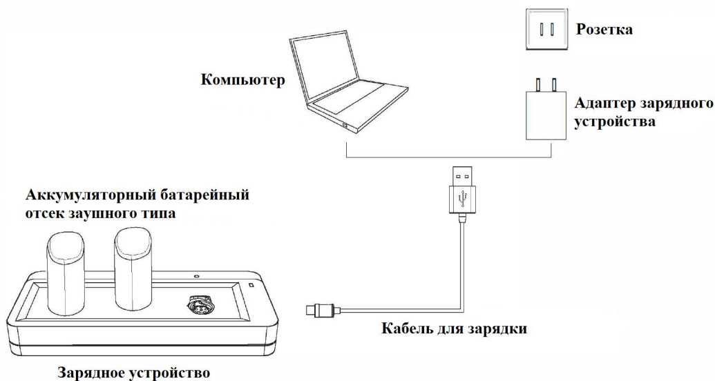
Рисунок 14. Схема подключения аккумуляторного блока питания для ЗТН
