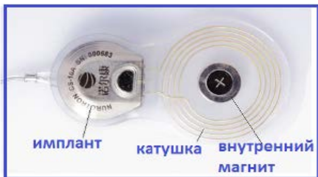
Рис. 1 Схема расположения магнита импланта
