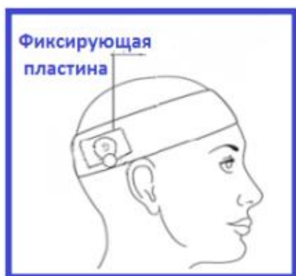
Рис. 4 Расположение фиксирующей пластины
