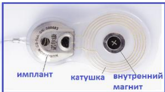
Рис. 1 Схема расположения магнита импланта
